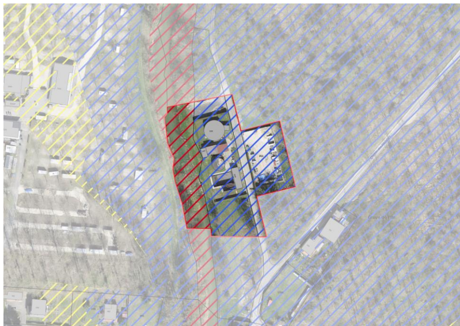
Figure 4 : Représentation des dangers d'inondations par les crues au sein du périmètre du PA STEP d'Yvonand. Les dangers élevés sont représentés en rouge et les dangers moyens en bleu.
