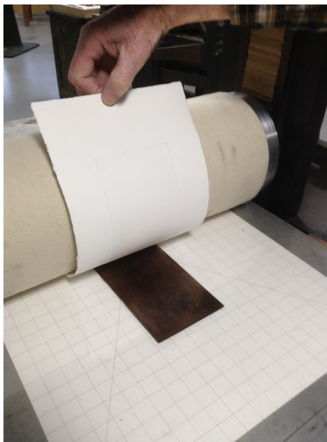
Passage du cliché sous le cylindre avec le papier et le molleton
