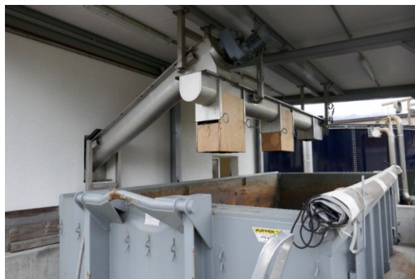
Figure 29 : Exemple de vis de répartition des boues dans la benne
